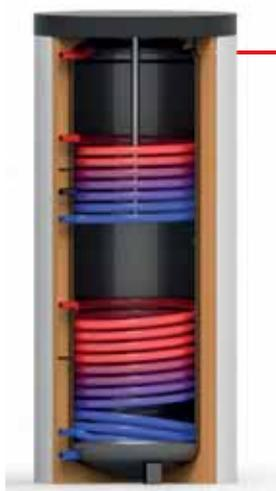
Préparateur d'eau sanitaire sous forme d'accumulateur à collecteur vertical en acier S235JR comprenant isolation en mousse rigide PU et jaquette de 5 mm en RAL 906 Argent, Protection anticorrosion côté eau sanitaire par émailage selon DIN 4753 et anode en magnésium.
