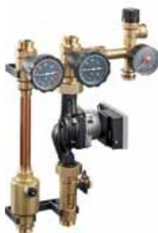
Avec Wilo-Yonos PARA 25/7 PWM, 2-15 l/min, DN25, avec purgeur et groupe de sécurité Unité prémontée intégralement, à étanchéité contrôlée pour le circuit solaire. Raccord à filetage mâle 1" avec bagues de serrage
