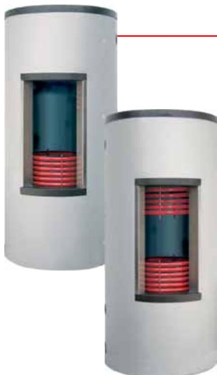
Accumulateur stratifié en acier à fond bombé, avec apprêt anticorrosion externe, équipé d'une cage de stratification spéciale à l'intérieur pour une stratification précise de la température, avec grand collecteur à tube lisse en acier, soudé dans l'accumulateur, pour le chargement de l'accumulateur en énergie solaire p. ex., installation sur 3 ou 4 pieds ; des pieds réglables sont disponibles en option pour une compensation du niveau jusqu'à 30 mm.
